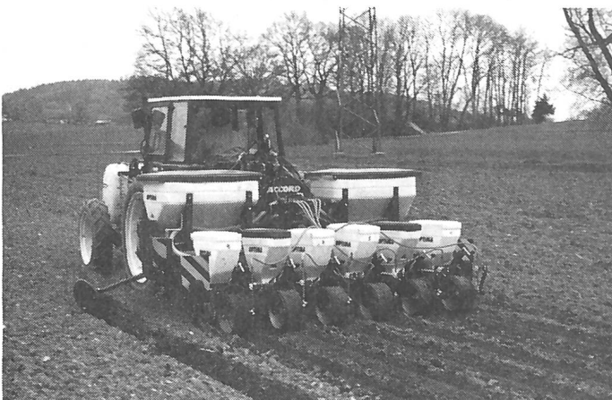
Abb. 1. Ackerbohnen-Einzelkornsaat mit gleichzeitiger Herbizidbandspritzung. Praktisch unkrautfreier Bestand nach zweimaligem Hacken (rechts).
