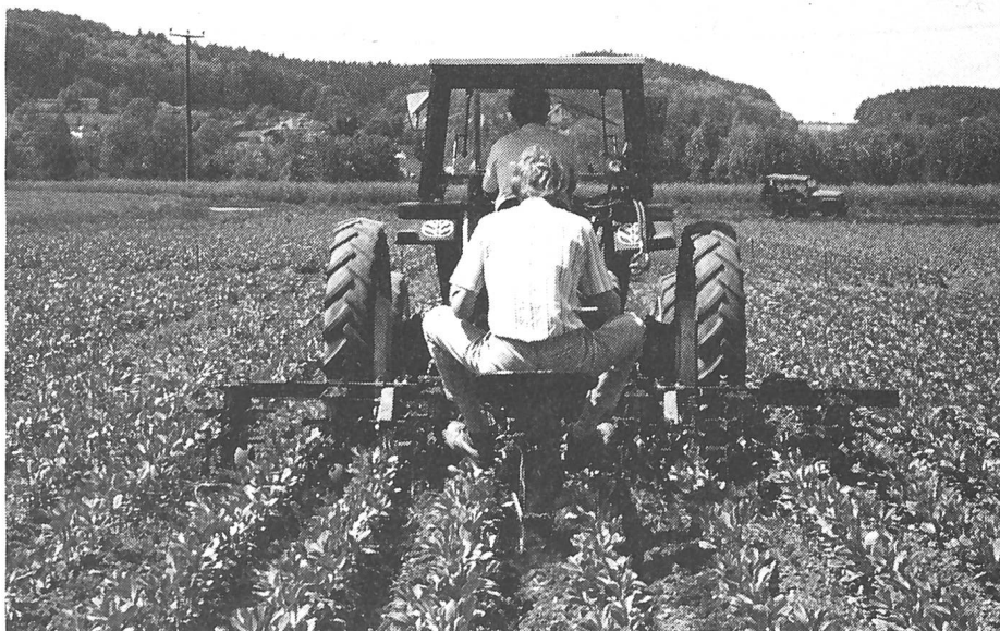
Abb. 2. Ein Rüben-Scharhackgerät ist auch in Ackerbohnen einsetzbar. Von links: erste bzw. zweite Durchfahrt, Hacksatzbreite 33 cm bei Winkelmesser bzw. 28 bis 30 cm bei Gänsefußscharen.
