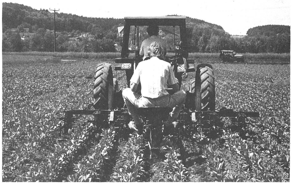
Abb. 2. Ein Rüben-Scharhackgerät ist auch in Ackerbohnen einsetzbar. Von links: erste bzw. zweite Durchfahrt, Hacksatzbreite 33 cm bei Winkelmesser bzw. 28 bis 30 cm bei Gänsefusscharen.
