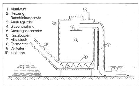
Schema der Anacom-Pilotanlage.
