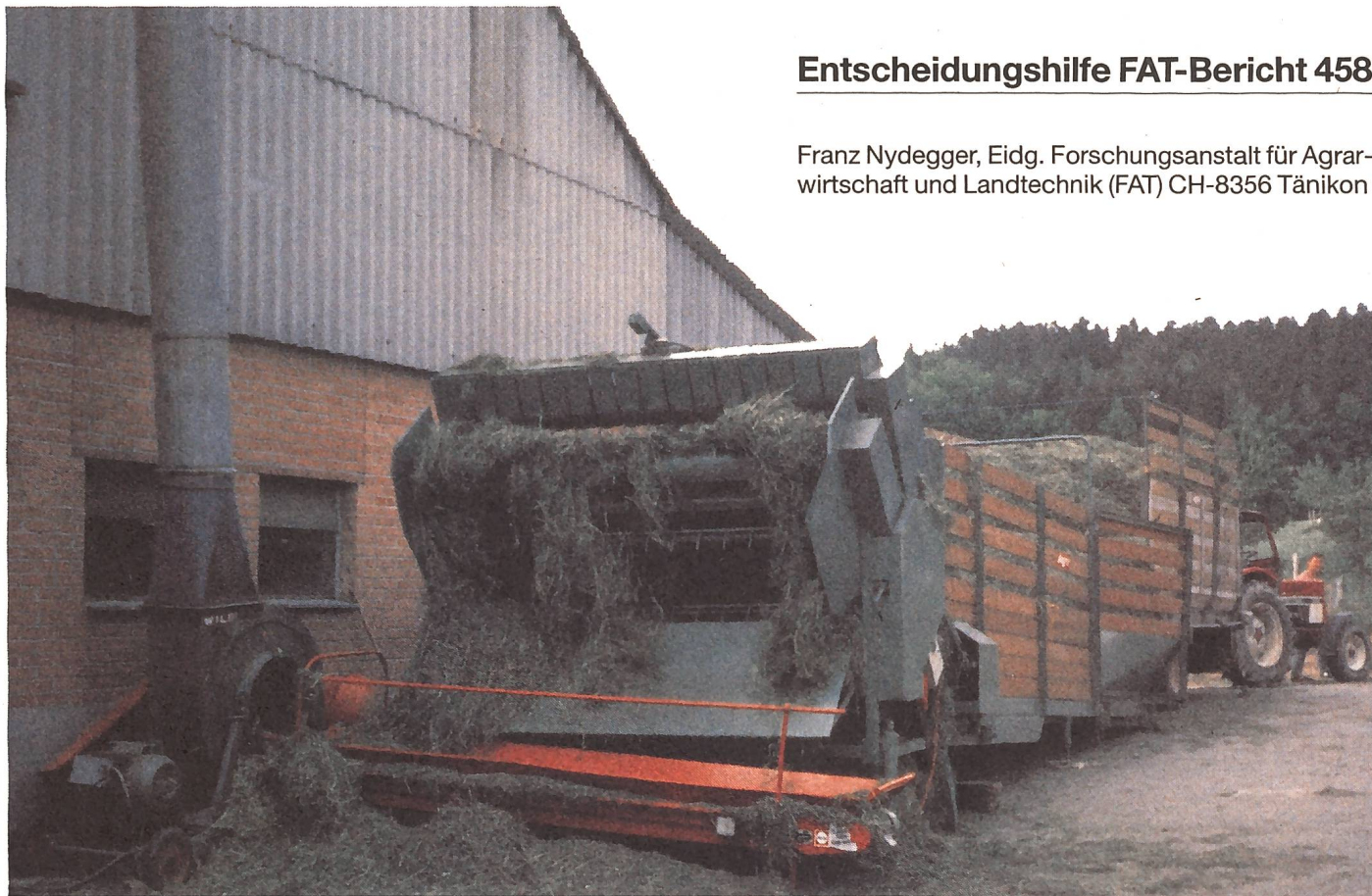
Ein Dosiergerät kann die schwere Arbeit der Gebläsebeschickung übernehmen, verteuert aber die Gebläsevariante.
