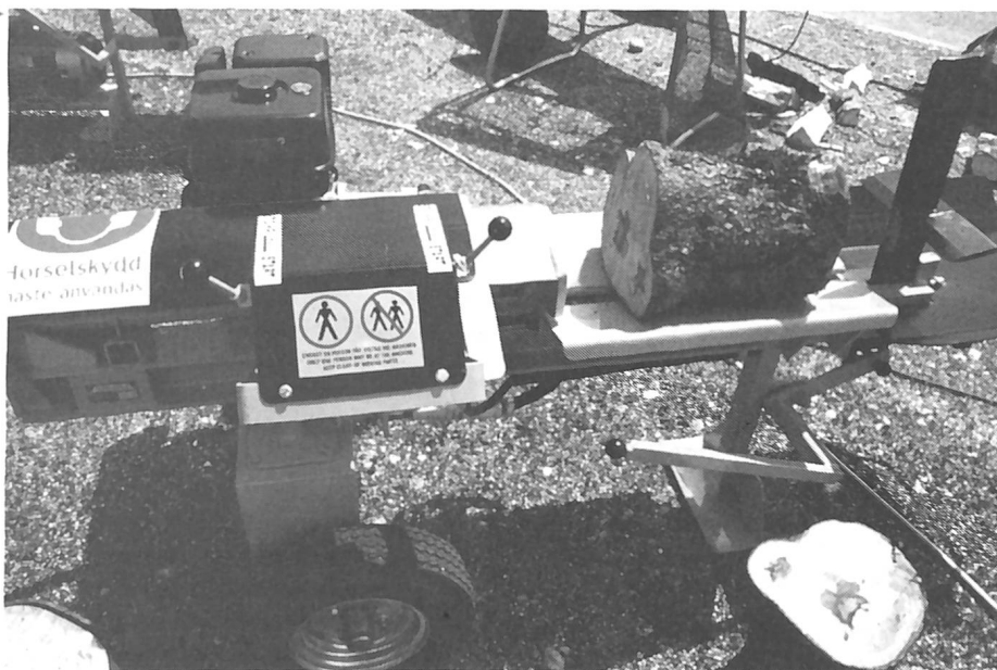
Die Zweihandschaltung muss das Festhalten des Holzes und das Auslösen des Spaltvorganges bequem und sicher ermöglichen. Am Keilspalter sind beidseitig Auffangbügel angebracht.
