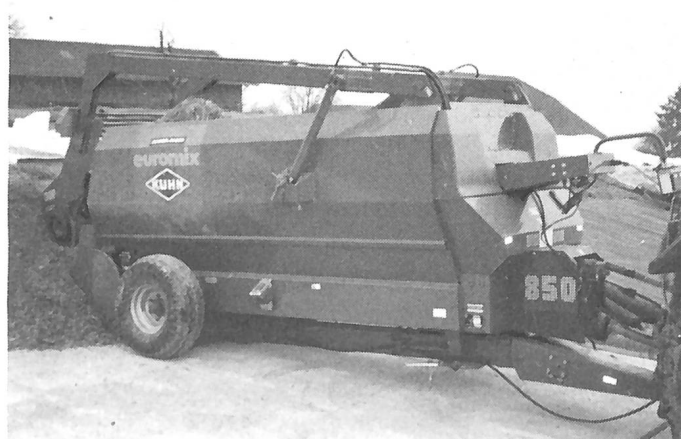
Euromix-Siloentnahme, Mischen, Wägen und exaktes Verteilen mit einer Maschine.
