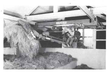
Die neuen Bächtold-Heukrane Typ BA 800 und BA 1000 sind zurzeit die anpassungsfähigsten und modernsten Krananlagen auf dem Markt. Die Krananlagenreihe wird im Baukastenprinzip hergestellt. Wahlweise stehen Traglasten von 800 kg oder 1000 kg zur Verfügung. Mit verschiedenen Armlängen und einer Ausladung von 2,3 m (eingefahren) und 10,4 m (ausgefahren) sind die Krananlagen vielseitig einsetzbar.
