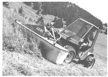
Der allerneuste Geräteträger Aebi Terratrac TT60. Mit vier Lenkungsarten, einem total neuen Kühlerkonzept, hydrostatischem Antrieb und einem multifunktionalen Fahrhebel, mit dem man alles Wichtige im Griff hat.
