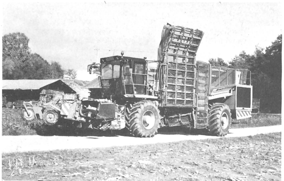
Der 6reihige selbstfahrende Holmer-Köpfrödebunker.
