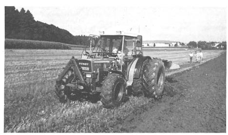
Das Offset-Pflügen schont den Boden, erfordert aber vom Fahrer eine präzise Lenkarbeit. Doppelräder und Frontgewichte verbessern die Spurtreue.
