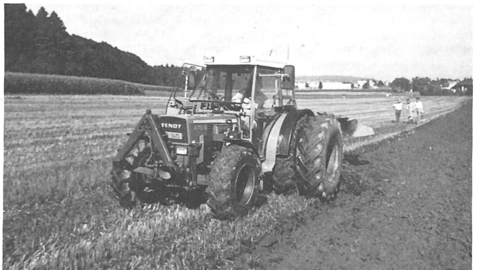
Das Offset-Pflügen schont den Boden, erfordert aber vom Fahrer eine präzise Lenkarbeit. Doppelräder und Frontgewichte verbessern die Spurtreue.
