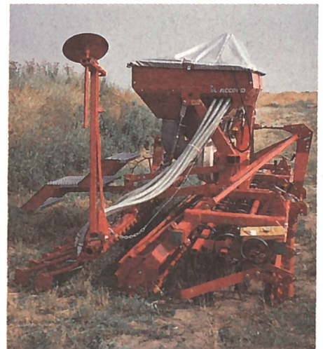
Mit einem Pflugschlepper kann ein Arbeitsgang eingespart werden. Durch den speziell stabilen Packerarm (mit dem drehbar montierten Nachläufer) kann ein Teil des Pfluggewichtes auf den Ringpacker abgestützt und somit der Packer belastet werden. (Photo: Kramer)
