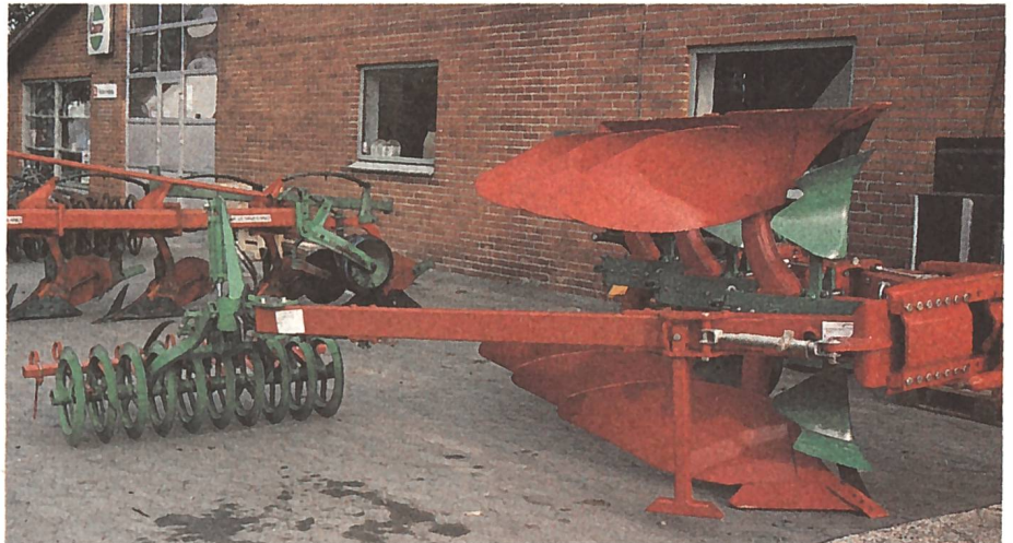
Mit einem Pflugschlepper kann ein Arbeitsgang eingespart werden. Durch den speziell stabilen Packerarm (mit dem drehbar montierten Nachläufer) kann ein Teil des Pfluggewichtes auf den Ringpacker abgestützt und somit der Packer belastet werden. (Photo: Kramer)
