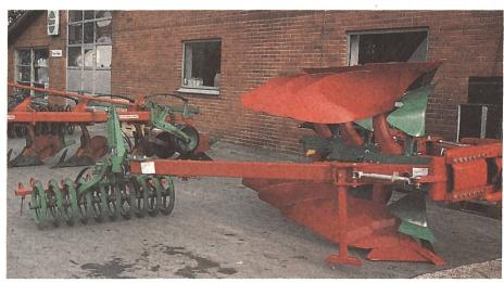
Mit einem Pflugnachläufer kann ein Arbeitsgang eingespart werden. Durch den speziell stabilen Packerarm (mit dem drehbar montierten Nachläufer) kann ein Teil des Pfluggewichtes auf den Ringpacker abgestützt und somit der Packer belastet werden.
