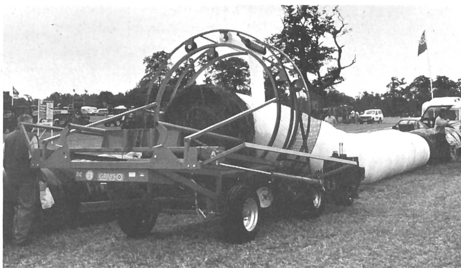
Mit dem Strangwickelverfahren lässt sich der Folienverbrauch halbieren. Es lohnt sich aber nur, wenn grosse Mengen gleichzeitig geerntet werden.
