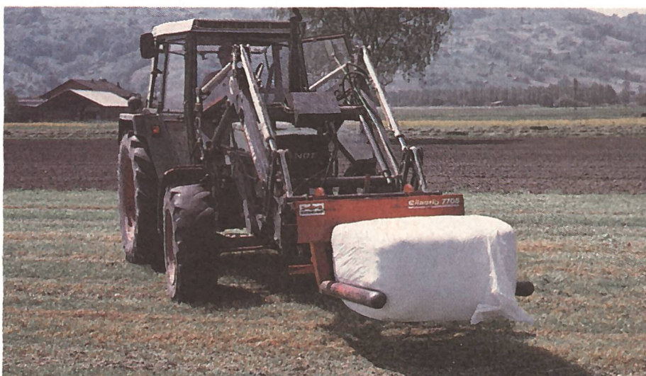
Grossballen können mit einfachen Geräten am Frontlader oder Heckhubwerk transportiert werden. Die Ballenzange geht mit Wickelballen sehr schonend um.
