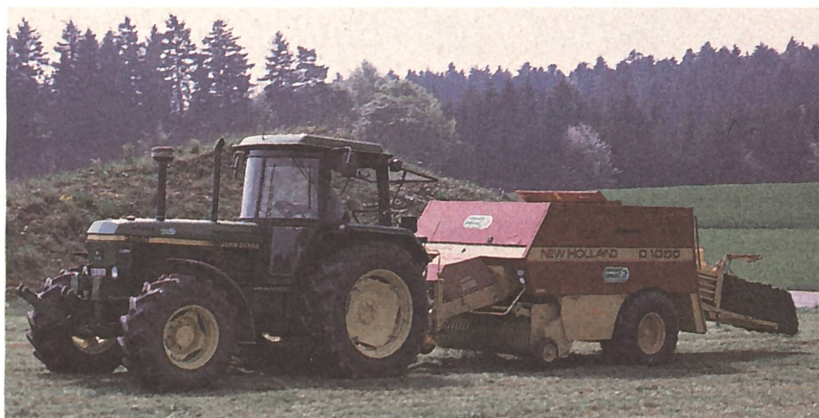
Quaderpressen sind schwere Maschinen von 4 bis 8 t Eigengewicht und erfordern leistungsfähige Traktoren von 75 bis 90 kW. Die Verfahrensleistungen auf dem Feld und die Pressdichte sind sehr hoch.
