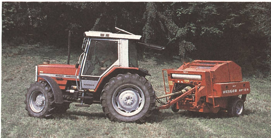
Rundballenpressen sind leichte Maschinen und erfordern Traktoren der mittleren Leistungsklasse von 50 bis 60 kW. Deshalb sind sie auch für mässige Hanglagen geeignet. Die Ballen müssen aber auf flachen Stellen ausgeworfen werden.
