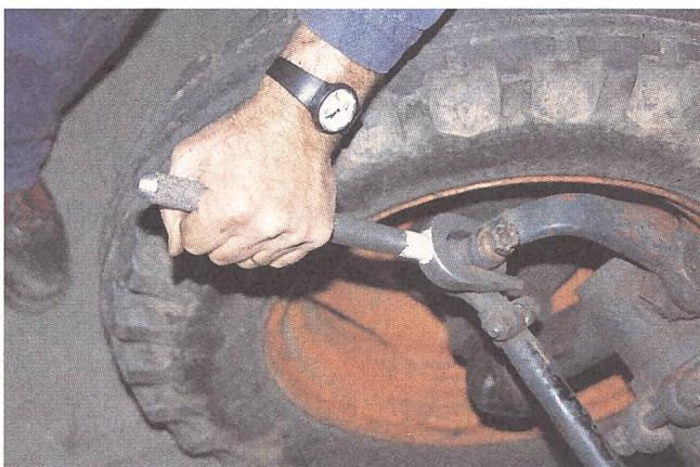
3. Am defekten Kugelgelenk wird zunächst der Splint entfernt und die Kronenmutter einige Umgänge gelöst. Den konischen Gelenkbolzen, welcher im «Auge» des Hebels fest-sitzt, durch kräftige Schläge seitlich an das Auge lösen (zwei-ten Hammer auf der Gegenseite hinhalten). Die Trengabel (Bild) wird zwischen Kugelgelenk und Auge getrieben und ist vor allem da hilfreich, wo zu wenig Platz für das Gegenstützen mit dem zweiten Hammer vorhanden ist.
