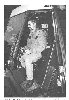
Abb. 3. Für die Lärmmessung wird das Messgerät links oder rechts vom Fahrerkopf montiert – je nachdem, wo der höhere Lärm gemessen wird. Die Messung erfolgt mit belastetem Motor.
