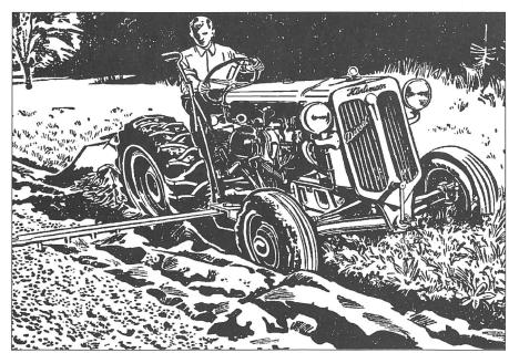
Bald sind es bereits 50 Jahre her seit der legendären, in allen Industriestaaten zum Patent angemeldeten Erfindung der Hürlimann-Motoregge. Sie ermöglichte erstmals die Saatbettzubereitung (Pflügen und Eggen) in einem einzigen Arbeitsgang. Diese und viele andere Schweizer Pionierkonstruktionen auf dem Gebiet des Landmaschinenbaus u.a. fast sämtliche je in der Schweiz fabrizierten Traktormarken werden an der Agro-Oldtimerschau vom 6./7. August in Tänikon bei Aadorf zu besichtigen sein.
