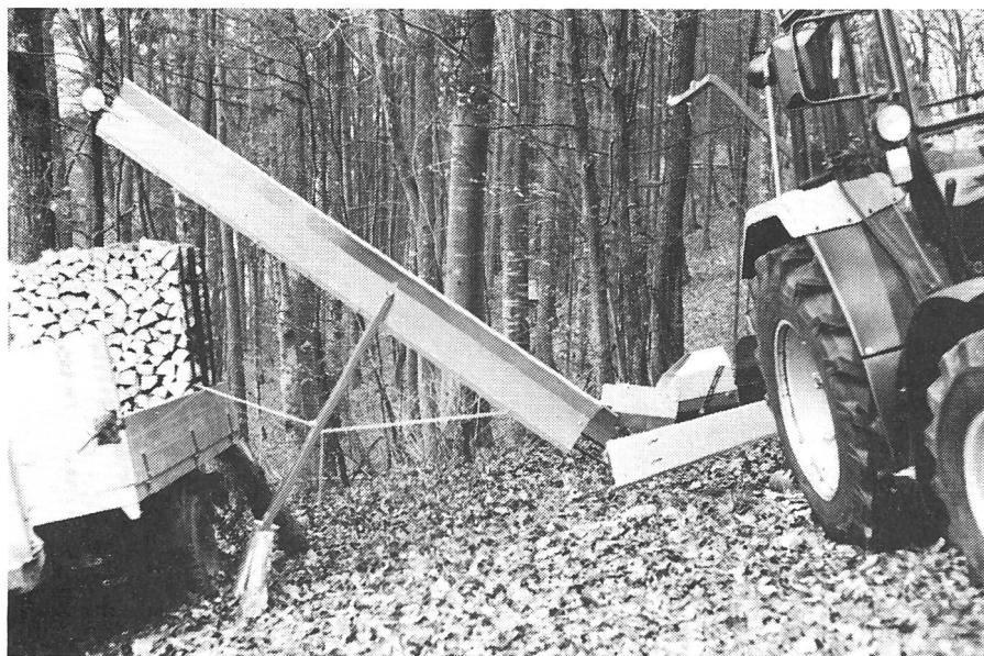
Finnische Säge-Spaltmaschine (Zapfwellenantrieb) für die Aufrüstung von Stückholz im Wald.
