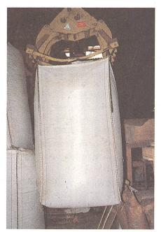
Wird beim Güterumschlag mit angebautem Greifer gearbeitet, benötigt der Kran 150–200 kg mehr Hubkraft als ohne Greifer.
