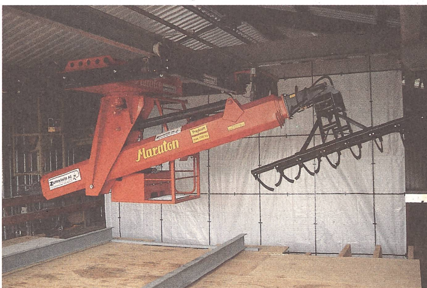
Krananlagen beanspruchen im Gebäude einen Funktionsraum (Durchfahrtsraum). Wichtig sind dabei die Höhe und die Breite (Ausleger quer zur Fahrbahn) des Krans.
