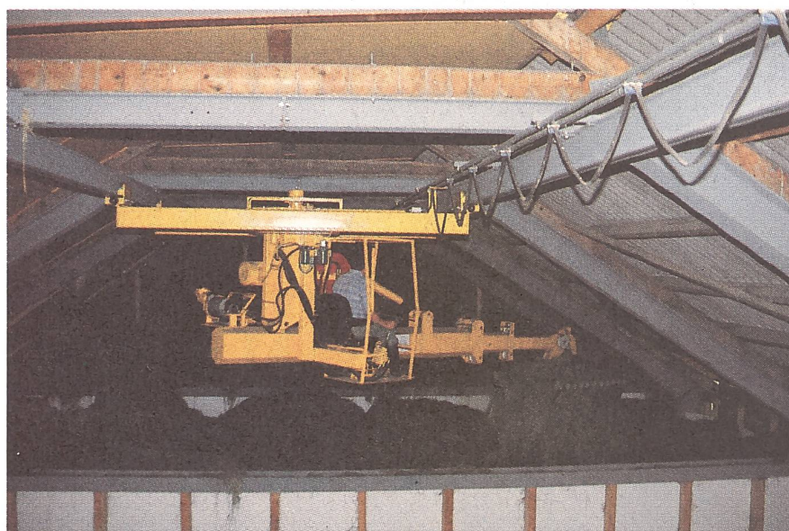
Bei Messungen zeigte sich, dass die Belastungen der Fahrwerke und damit der Schienen und des Gebäudes je nach Krantyp und Nutzlast recht unterschiedlich sind.
