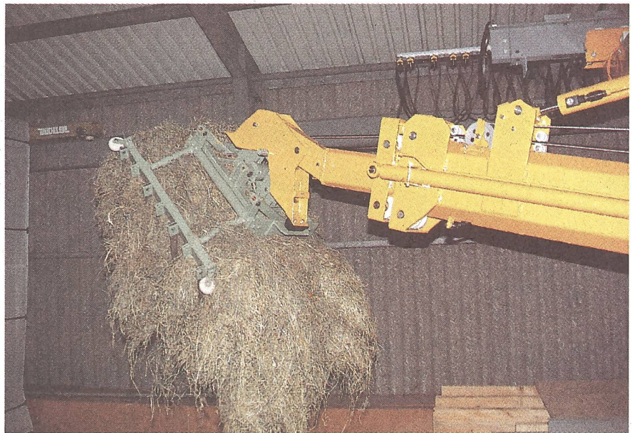
Herabhängendes Futter beansprucht etwa 50 cm. Eine Greiferhochstellung erleichtert das Füllen des Stockes.
