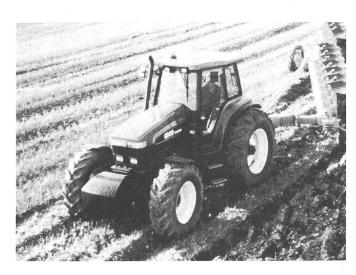
das Antippen des Schalthebels nach rechts oder links hochoder runtergeschaltet. Bei Transportarbeiten schaltet man einfach auf Automatik, die Getriebe schalten dann vollautomatisch hoch und runter. Ebenfalls programmierbar ist das Verhältnis der Vorwärts- zu den Rückwärtsgeschwindigkeiten.
