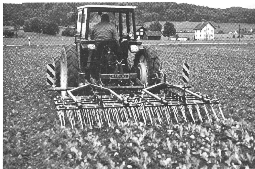
Abb. 1 Ein früher Striegeleinsatz erhöht die Unkrautbekämpfung, aber auch die Verletzungsgefahr der Rapspflanzen. Runde und hohe Zinken, mässiger Federdruck und Fahrgeschwindigkeit sowie Spurlockerer sind empfehlenswert.
