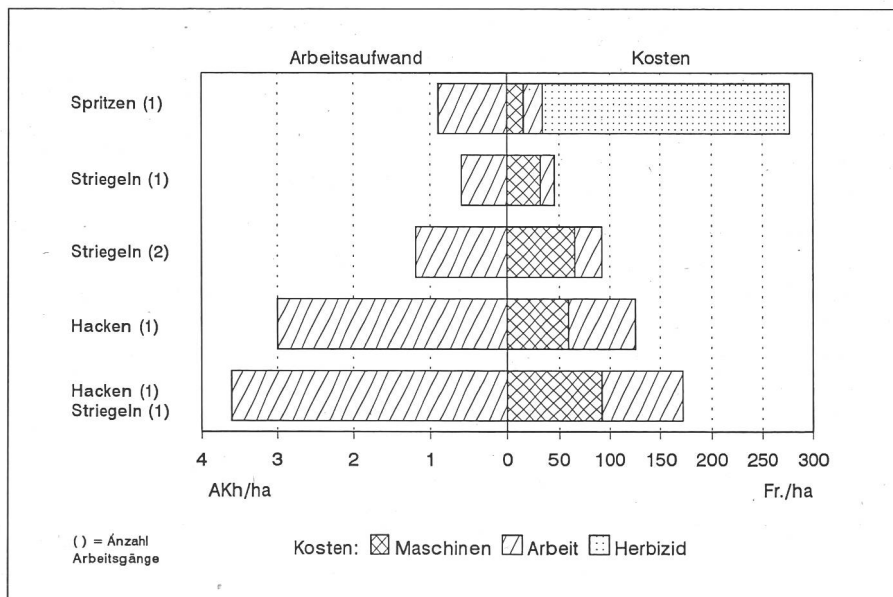
Abb. 4 Arbeitsaufwand und Kosten der Unkrautbekämpfungsverfahren im Raps bei Miete der Hack- und Striegelgeräte (ohne Fixkosten des Traktors bzw. der Feldspritze). Ansätze gemäss FAT-Bericht Nr. 436: Traktor 33 kW (45 PS), Spritzen (12 m), Striegel (6 m) Fr. 27.-/ha, Hackgerät (3 m) Fr. 44.-/ha, Arbeit Fr. 22.-/AKh.
