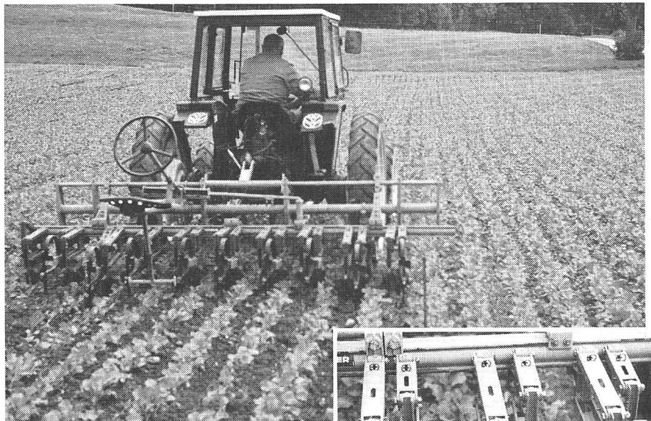
Abb. 2 Mit dem Hackgerät wurden die Unkräuter zwischen den Reihen bekämpft und die Reihen leicht angehäufelt.
