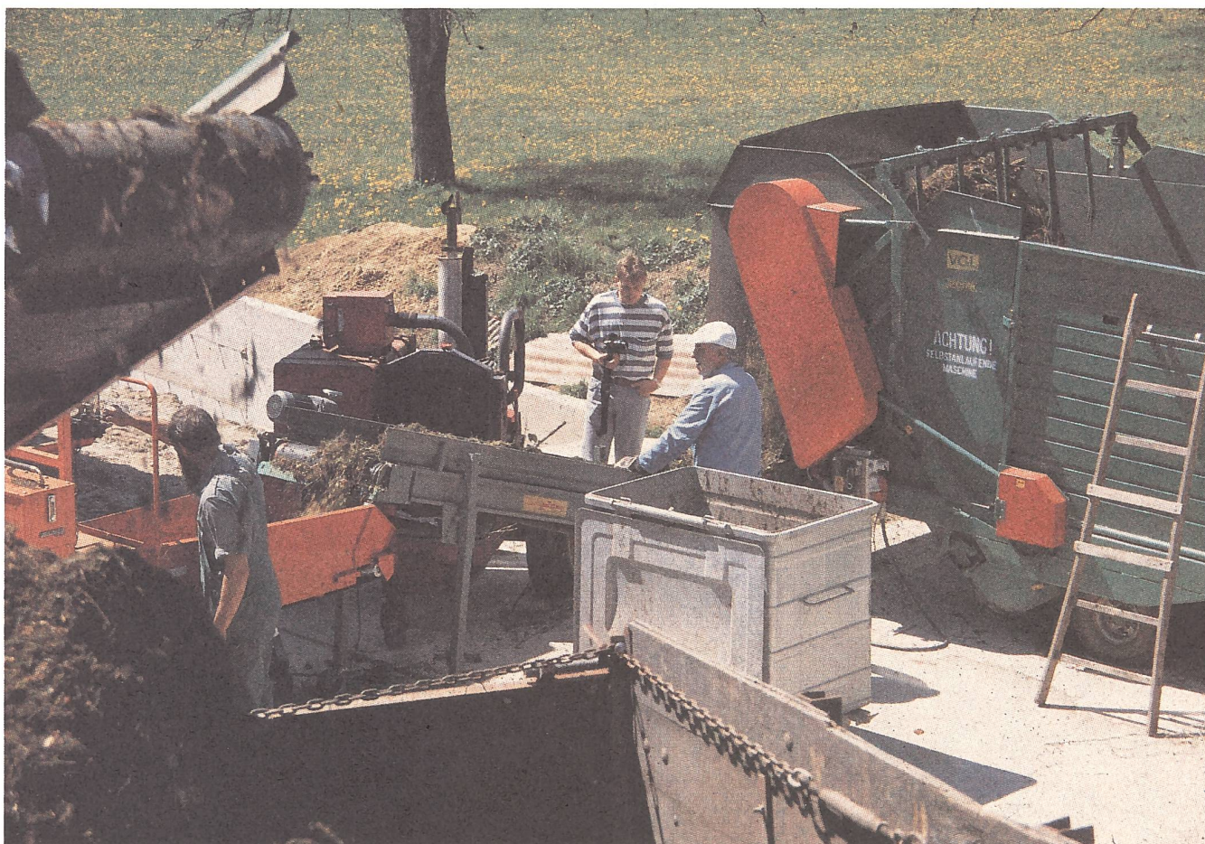
Durchdachte Verarbeitungskette im landwirtschaftlichen Massstab: Dosiergerät, Verleseband, Schredder, Förderband, Kipper (Photos: Willi von Atzigen)
