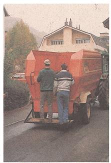
Innovation ist gefragt: Mit dem Futtermischwagen ist auch beim Kompost für eine zuverlässige Durchmischung gesorgt. (Photo: Büro Composto)
