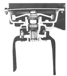
Ein Kugelhagel aus Kugellagern kann den Antrieb zerstören und sehr teuer werden! Aber nur wenn die Kugellager <u>über</u> den Zahnrädern montiert sind!
