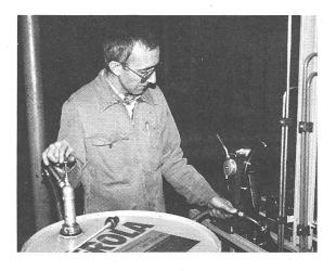
Zum Dauerbrenner haben sich die Demonstrationen und Kurse betreffend hydraulische Bremsen auf landwirtschaftlichen Anhängerzügen entwikkelt. Diese Tests werden im Programm bleiben, wird doch mit einigem Erstaunen festgestellt, dass die Druckregulierung des Bremsöles auch auf neuen Traktoren häufig nicht dem normierten Verlauf entspricht.
