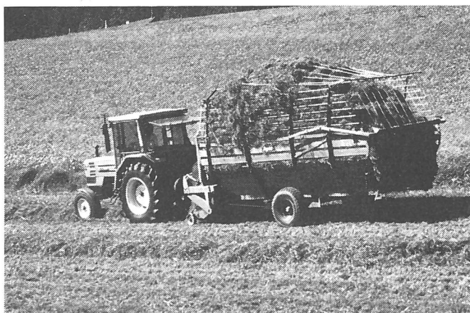
Abb. 2a (links) und 2b (rechts): Bergen von Grassilage mit einem vielseitig einsetzbaren Ladewagen und einem speziellen Felddäcksler.
