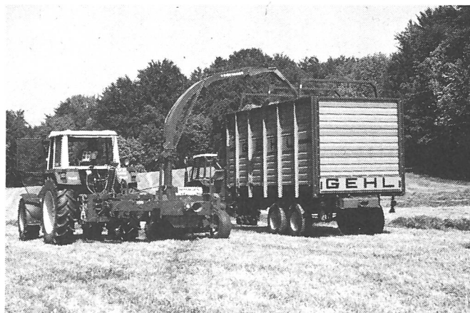
Abb. 2a (links) und 2b (rechts): Bergen von Grassilage mit einem vielseitig einsetzbaren Ladewagen und einem speziellen Felddäcksler.
