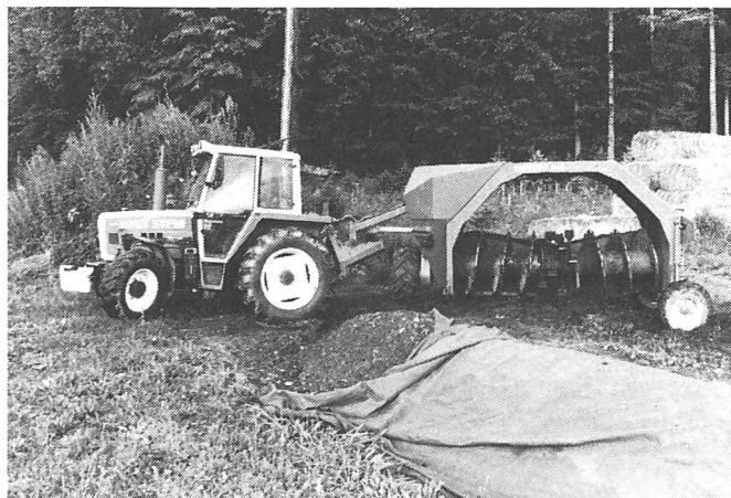
Traktorbetriebene Kompostwendemaschine TOPTURN 300 von AEBI-KOMPTECH für die Feldwegkompostierung. Eine Traktorleistung von 60 PS genügt bereits für den Antrieb.
