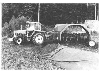
Traktorbetriebene Kompostwendemaschine TOPTURN 300 von AEBI-KOMPTECH für die Feldwegrandkompostierung. Eine Traktorleistung von 60 PS genügt bereits für den Antrieb.
