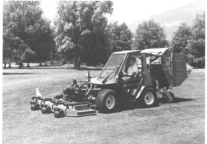
Der allerneueste Geräteträger Aebi Terra-trac TT60. Mit vier Lenkungsarten, einem total neuen Kühlerkonzept, hydrostatischem Antrieb und einem multifunktionalen Fahrhebel, mit dem man alles Wichtige im Griff hat.
