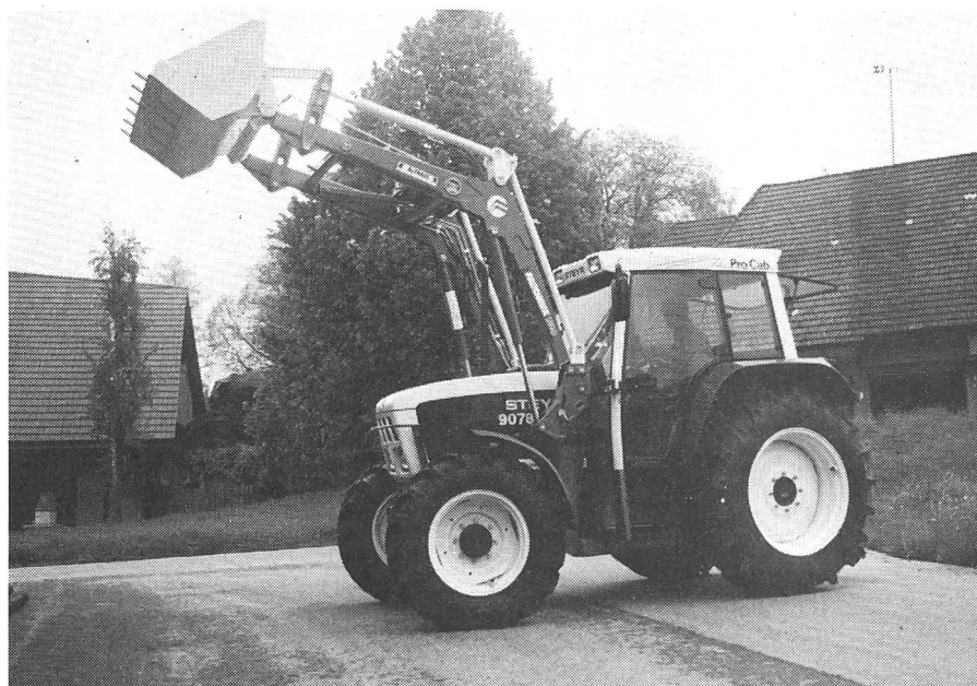
Mit den neuen integrierten Konsolen bilden Traktor und Frontlader eine Einheit.
