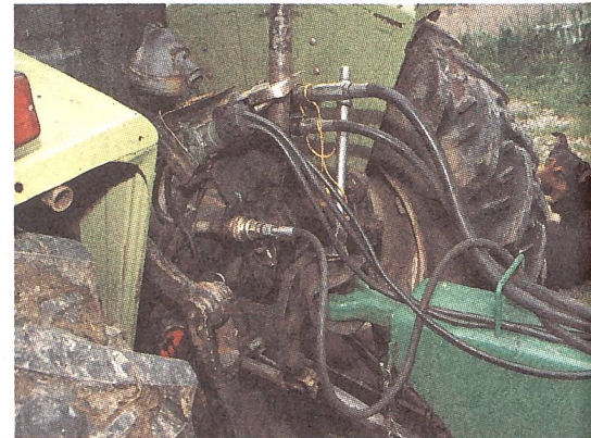
Traktor: Universelle Antriebsquelle über Hydraulik, Zapfwelle und sogar die Batterie.
