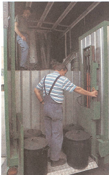
Hebebühne aus einem umfunktionierten Hubstapler.
