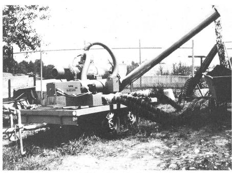
Abb. 1. Siebschnecke als fahrbare Anlage im überbetrieblichen Einsatz.
