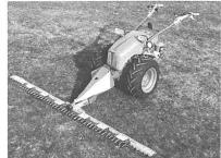
Dank dem neuen Mähbalken mit zwei verstopfungsfreien Schneidwerken. Passend zu allen RAPID- und AEBI-Mähern. Balkenbreiten: 1,60; 1,90; 2,03; 2,20 und 2,50 m Hersteller:
