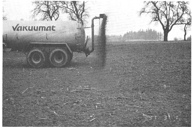
Abb. 5: Druckfass mit Prallkopfverteiler: Durch Höher- oder Tieferstellen des Verteilers kann die Arbeitsbreite je nach den Erfordernissen in einem Bereich von 10 bis 14 m eingestellt werden. Er eignet sich besonders für die Güllendüngung im Acker mit vorgegebenen Fahrgassen.
