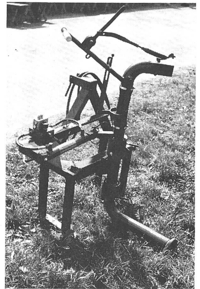
Abb. 11: Schwenkverteiler – hier mit hydraulischer Steuerung – ermöglichen Arbeitsbreiten bis 25 m. Im Ackerbau sind sie den Pralltellern vorzuziehen, da die Gerätschaften weniger häufig umgestellt werden müssen.
