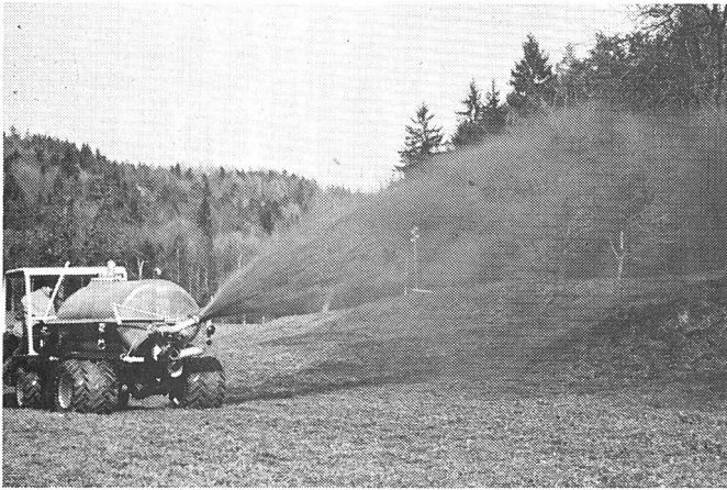
Abb. 4: Soweit die Wurfweite reicht, kann nicht befahrbares Gelände auch mit dem Pumpfass mit Weitwurfdüse begüllt werden. Behälter aus Kunststoff haben den Vorteil, dass man immer sieht, wieviel Gülle noch im Fass ist.
