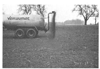
Abb. 5: Druckfass mit Prallkopfverteiler: Durch Höher- oder Tieferstellen des Verteilers kann die Arbeitsbreite je nach den Erfordernissen in einem Bereich von 10 bis 14 m eingestellt werden. Er eignet sich besonders für die Gülledüngung im Acker mit vorgegebenen Fahrgassen.
