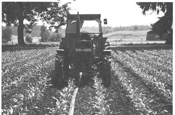
Abb. 9: Die Verschlauchung ist auch im Ackerbau verwendbar: Damit die Maispflanzen keinen Schaden erleiden, werden die Schläuche zwischen den Maisreihen ausgelegt und während der Verteilarbeit in der gleichen Zwischenreihe zurückgezogen.
