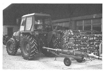
Abb. 7: Für die Gülleverschlauchung sind heute Schneckenpumpen am meisten verbreitet. Um die hohe Antriebsleistung sicherzustellen, werden sie oft über die Zapfwelle angetrieben. Um bei Verstopfungen in der Leitung Schäden zu vermeiden, sollten Pumpen auf der Druckseite mit einer Überdrucksicherung ausgerüstet sein.
