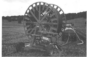
Abb. 14: Güllen mit dem Beregnungsautomat: Der aufgebaute Benzinmotor garantiert einen problemlosen, vom Güllestrom unabhängigen Betrieb und eine genügend hohe Einzugsgeschwindigkeit des Regners.
