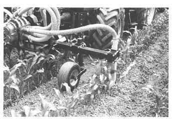
Abb. 13: Drillgerät (5reihig) im Frontanbau: Die aufgebaute Pumpe verteilt die Gülle vom gezogenen Fass auf die einzelnen Drillkörper. Durch das direkte Einleiten werden gasförmige N-Verluste praktisch unterbunden.
