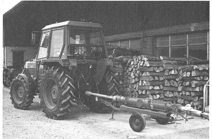
Abb. 7: Für die Güllerverschlauchung sind heute Schneckenpumpen am meisten verbreitet. Um die hohe Antriebsleistung sicherzustellen, werden sie oft über die Zapfwelle angetrieben. Um bei Verstopfungen in der Leitung Schäden zu vermeiden, sollten Pumpen auf der Druckseite mit einer Überdrucksicherung ausgerüstet sein.
