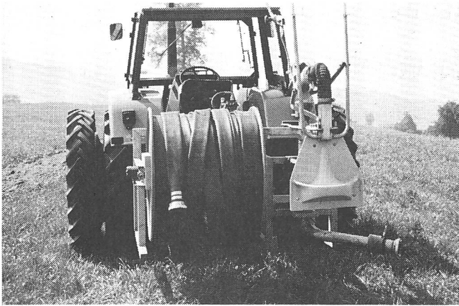
Abb. 10: Kombihaspel (Haspel mit Verteilautomat) haben den Vorteil, dass die Haspel nach dem Auslegen der Schläuche nicht abgehängt werden muss. Für schlecht zugängliche Restflächen kann der Prallteller vom Traktorsitz aus auf Handverteilung umgeschaltet werden.
