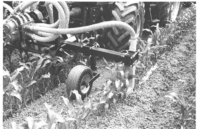
Abb. 13: Drillgerät (5reihig) im Frontanbau: Die aufgebaute Pumpe verteilt die Gülle vom gezogenen Fass auf die einzelnen Drillkörper. Durch das direkte Einleiten werden gasförmige N-Verluste praktisch unterbunden.
