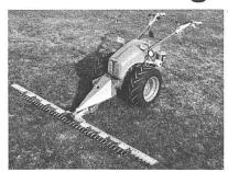
Dank dem neuen Mähbalken mit zwei verstopfungsfreien Schneidwerken. Passend zu allen RAPID- und AEBI-Mähern. **Balkenbreiten:** 1,60; 1,90; 2,03; 2,20 und 2,50 m
