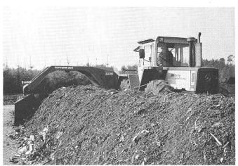
Die neue Kompostwendemaschine mit hydrostatischem Antrieb der regionalen Kompostieranlage Schwanental/Eglisau. Hier beim Umsetzen einer Miete.
