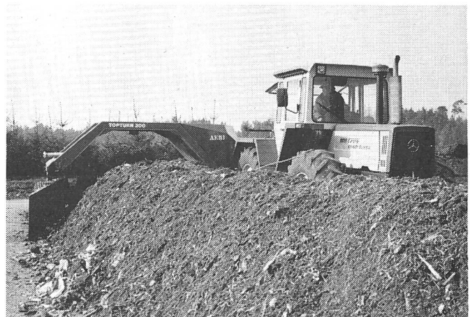
Die neue Kompostwendemaschine mit hydrostatischem Antrieb der regionalen Kompostieranlage Schwanental/Eglisau. Hier beim Umsetzen einer Miete.
