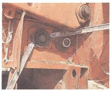
4. Falls kein Abziehwerkzeug zur Verfügung steht, kann das Lager mittels zweier Pneuheber sacht angehoben werden. Ein kräftiger Schlag auf die Welle löst das Lager und unterstützt die Hebelwirkung. Falls dies nicht genügt, empfiehlt es sich, das Lager durch kurze Erwärmung zu dilatieren.
