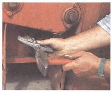
6. Es ist wichtig, dass die Greifer der Abziehvorrichtung entweder an der hinteren Lagerschale oder noch besser am Wälzlager direkt gut angreifen können. Wenn dies Schwierigkeiten macht, hilft man sich mit einem kräftigen Schlag auf das Gewinde der Vorrichtung, und im Notfall besteht wiederum die Möglichkeit zu wärmen (Punkt 4).
