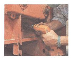
5. Steht eine Abziehvorrichtung zur Verfügung, die Mitte der Welle mit einem Körner markieren und einen Konus für den besseren Sitz der Abziehvorrichtung bohren.
