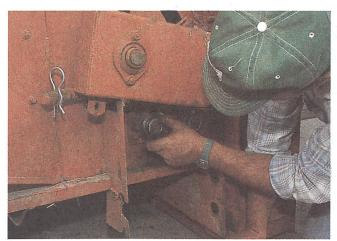
2. Vordere Wälzlagerschale demontieren.
