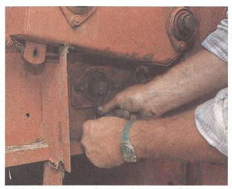
3. Die Lagerwelle von Staub und Schmutz reinigen sowie oberflächliche Rost- und Farbspuren mit feinem Glaspapier abschleifen.
