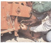
10. Den Excenterring aufsetzen und mittels Durchschlag im Uhrzeigersinn festklemmen und mittels Imbusschlüssel festziehen. Zw.
