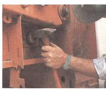
8. Allfällige Brauen mit einer Feile glätten und die Welle mit Glaspapier gut reinigen. Anschliessend das neue Wälzlager sorgfältig auf die Welle pressen und mit dosierten Hammerschlägen einpassen. Mit weiteren Hammerschlägen rund um die Welle auf einen Durchschlag, auf ein Rohr mit dem Querschnitt der Welle oder auf ein Hartholzstück das Lager an die richtige Stelle bewegen.
