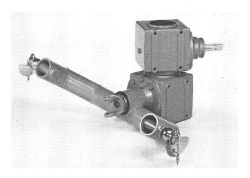
Schwenkgetrieben wurde die Anbindung an die Unterlenker des Schleppers deutlich verbessert, d.h. optimierte Kraftübertragung und verbesserte Freiheitsgrade.
