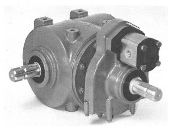
In Ergänzung dieses Baukastens entwickelte Walterscheid ein Getriebe GT 60 mit integriertem Hydraulik-Pumpenantrieb (Bild 7). Das Getriebe ist so ausgelegt, dass die Hydro-Pumpe bei den Standardantriebsdrehzahlen der Maschinen im wirtschaftlichen Bereich arbeitet. Die vermehrt in den komplexen Landmaschinen installierte Bordhydraulik (Hydro-Zylinder, Hydro-Motor) wird nunmehr durch diese neue Entwicklung angetrieben.
