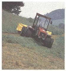
Kreiselmähwerk am bodenschonenden Zweiachsmäher mit Breitbereifung.
