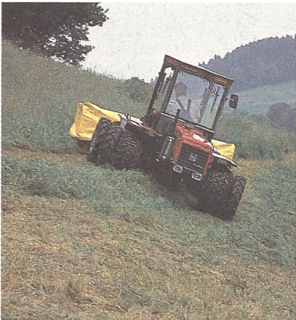
Kreiselmähwerk am bodenschonenden Zweiachsmäher mit Breitbereifung.
