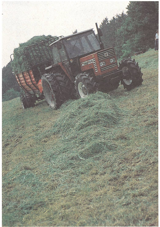
Die Universalmaschine «Traktor», ergänzt mit gewissen Zusatzausrüstungen, wie Doppelbereifung und (gelenkte) Triebachse, übernimmt den Fall auch im steilen Gelände.
