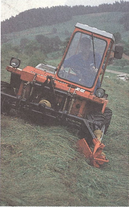
Doppelmessermähwerk an der Front oder am Heck, eine wirtschaftliche Lösung mit reduziertem Leistungsbedarf ...
