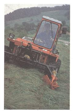
Doppelmessermähwerk an der Front oder am Heck, eine wirtschaftliche Lösung mit reduziertem Leistungsbedarf ...
