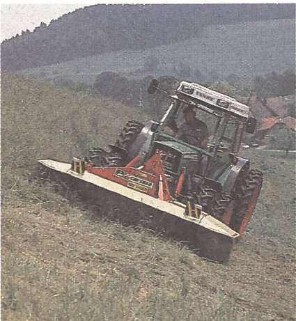
... oder am Traktor mit Doppelbereifung für die hohe Flächenleistung.
