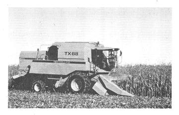
In der neuen Discovery-Kabine wird sich jeder Mähdrescher-Fahrer wohlfühlen. Die Kabine ist grossräumig, und die gewölbten Scheiben bieten eine freie Sicht auf den Schneidwerks- und Einzugsbereich. Sämtliche Bedienungsfunktionen werden per Knopfdruck betätigt. Mit einem Geräuschpegel von 76 dBA bietet die Discovery-Kabine einen sehr angenehmen Arbeitsplatz.
