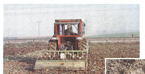
Lockern und Mischen mit der Pendelspatenmaschine; «Werkzeugabdruck».
