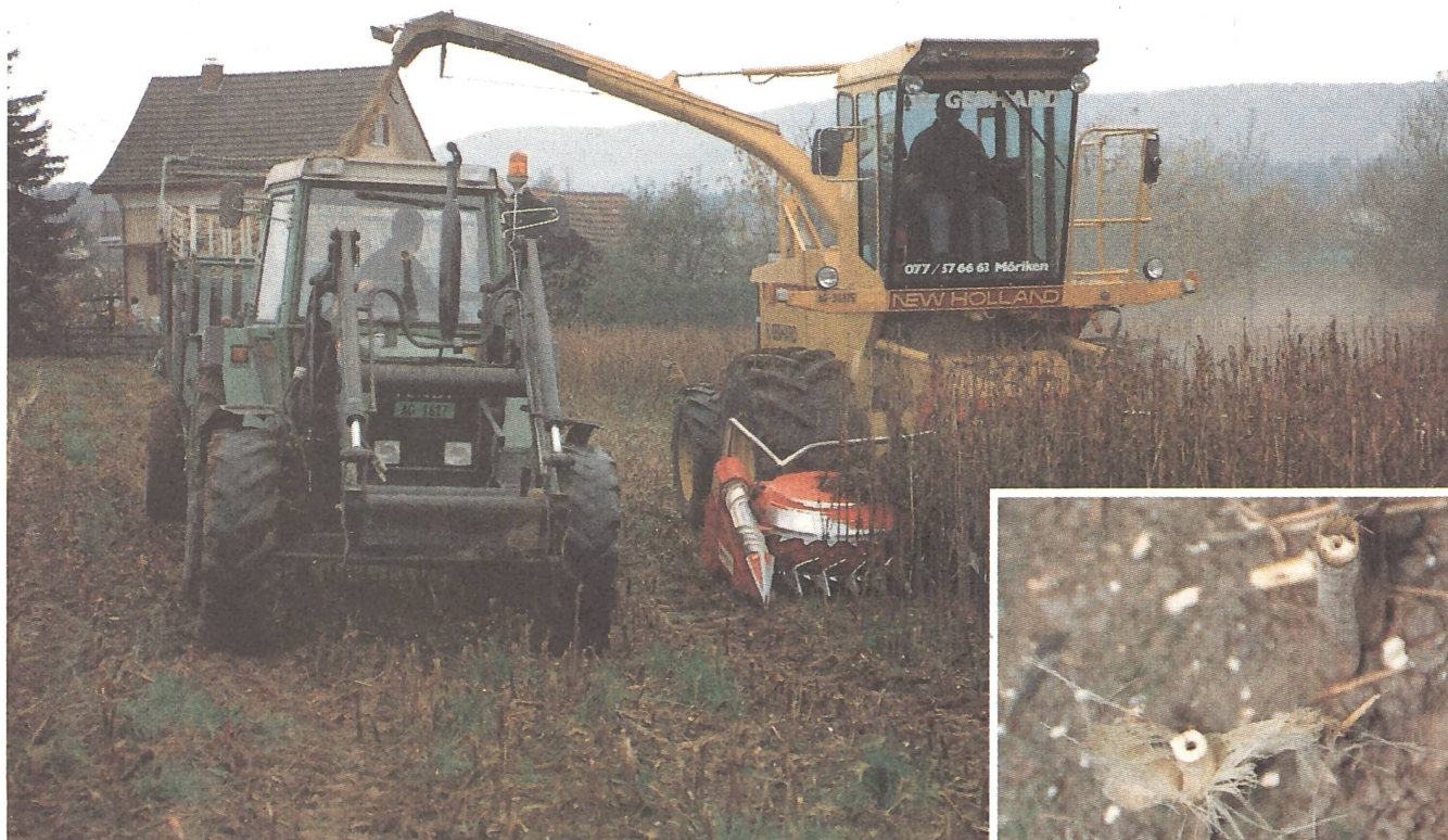
Kenaf und Chinaschilf: Der Feldhäcksler, ausgerüstet mit dem reihenunabhängigen Maisgebiss, scheint mit der grossen und faserigen Pflanzenmasse am besten fertig zu werden.
