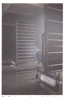
Die Bestimmung der vertikalen Verteilung der Pflanzenschutzmittel im Obstund Weinbau ist technisch anspruchsvoll. Heute verfügen nebst der FAT (die den Prüfstand gratis zu Verfügung stellt) lediglich die Aargauer, Luzerner und Zuger Obstproduzenten über einen Prüfstand.
