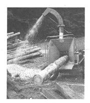
Grüngut ebensogut wie Holz bis zu einem Durchmesser von 600 mm. Die Korngrösse kann mittels Siebeinsatz gewählt werden.
