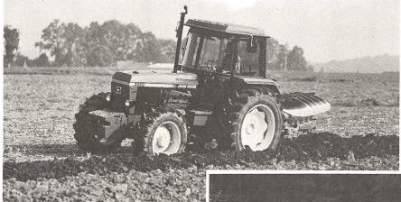
Mit Wasser gefüllte, wenig gepumpte Radialreifen und Frontgewichte erhöhen die Zugkraftübertragung des drehmomentstarken Motors und schonen den Boden dank weniger Schlupf und grösserem Kontaktflächendruck.
