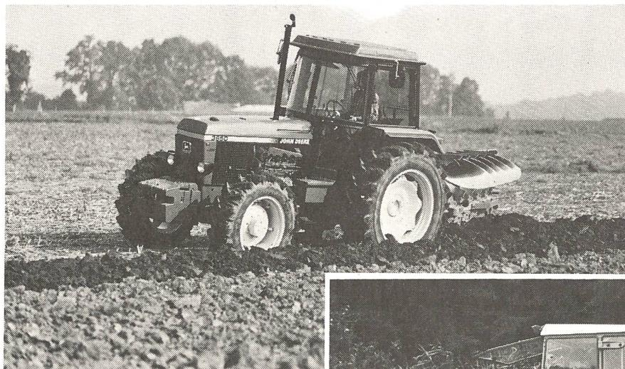
Mit Wasser gefüllte, wenig gepumpte Radialreifen und Frontgewichte erhöhen die Zugkraftübertragung des drehmomentstarken Motors und schonen den Boden dank weniger Schlupf und grösserem Kontaktflächendruck.
