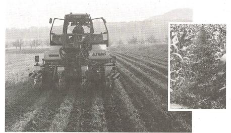
«Maiswiese». Mit dieser Bestellkombination fräsen Lohnunternehmer nach dem Frühjahrsschnitt 30 cm breite Streifen und lockern mit den vorlaufenden Grubberzinken knapp unterhalb der Bearbeitungsgrenze. Gleichzeitig erfolgen die Reihendüngung, die Einzelkornsaat und die Bandspritzung. Die quasi permanente Oberflächenbedeckung und Bodendurchwurzelung wirken sich besonders vorteilhaft auf Regenwasser-Infiltration und Befahrbarkeit sowie Bodenbiologie aus.
