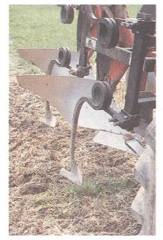
Lockerungszinken. Der Vorteil dieser Spiralfederzinken am Pflugkörper ist die zusätzliche Lockerung der befahrenen Furchensohle, unmittelbar hinter dem Traktorrad.
