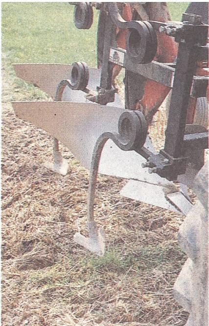
**Lockerungszinken.** Der Vorteil dieser Spiralfederzinken am Pflugkörper ist die zusätzliche Lockerung der befahrenen Furchensohle, unmittelbar hinter dem Traktorrad.
