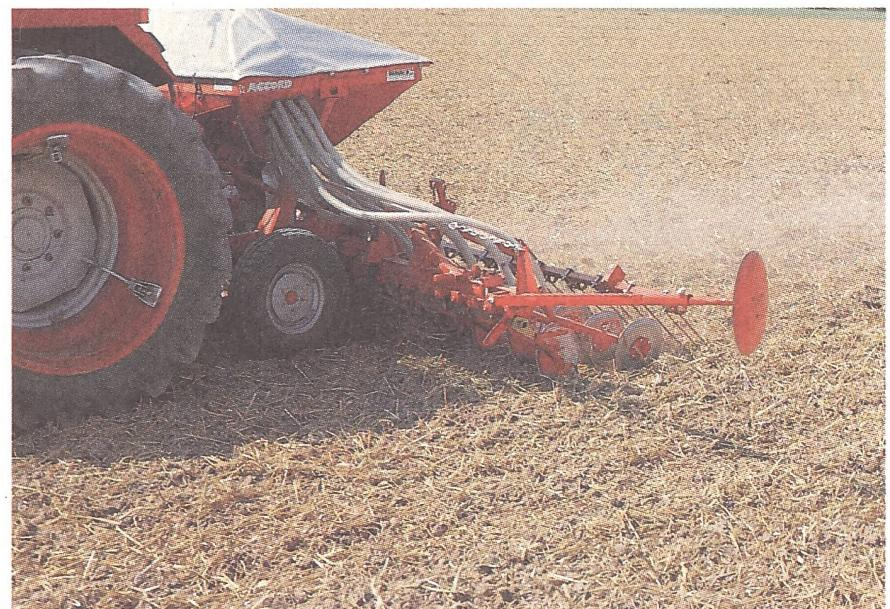
**Angepasste Sätechnik.** Bei der Getreidemulchsaat erfolgt die Saat in ganzflächig eingearbeitete Pflanzenreste. Scheibenscharen und Saatriegel ermöglichen eine gleichmässige, verstopfungsfreie Saatgutablage.
