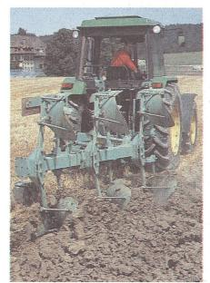
Offset-Pflügen. Untersuchungen von Braunschweig-Völkenrode zufolge beansprucht das Fahren in der Furche beim Pflügen den Unterboden am stärksten. Ist aus spezifischen Gründen das Pflügen notwendig, so sollten die Antriebsräder (Doppelbereifung möglich) auf der durchwurzelten und tragfähigen Bodenoberfläche ausserhalb der Furche laufen. In der Folge erübrigt sich eine Tieflockerung!
