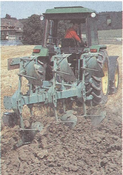
**Offset-Pflügen.** Untersuchungen von Braunschweig-Völkenrode zufolge beansprucht das Fahren in der Furche beim Pflügen den Unterboden am stärksten. Ist aus spezifischen Gründen das Pflügen notwendig, so sollten die Antriebsräder (Doppelbereifung möglich) auf der durchwurzelten und tragfähigen Bodenoberfläche ausserhalb der Furche laufen. In der Folge erübrigt sich eine Tieflockung!
