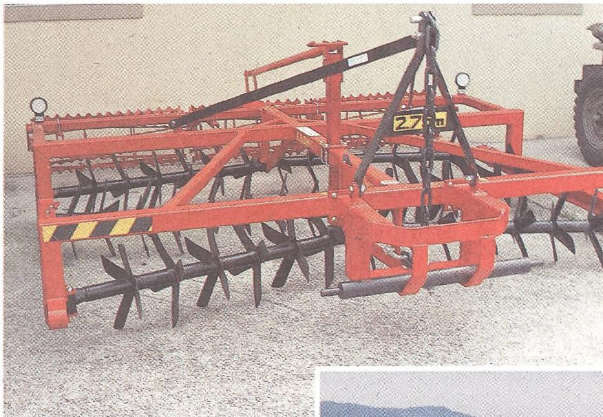
**Spatenrolle.** Dieses universelle, leichtzügige Gerät ermöglicht eine flache, strukturerhaltende und kostengünstige Bodenbearbeitung – mit oder ohne Pflanzenreste.
