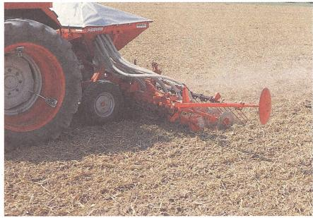
Angepasste Sätechnik. Bei der Getreidemulchsaat erfolgt die Saat in ganzflächig eingearbeitete Pflanzenreste. Scheibenscharen und Saatstriegel ermöglichen eine gleichmässige, verstopfungsfreie Saatgutablage.
