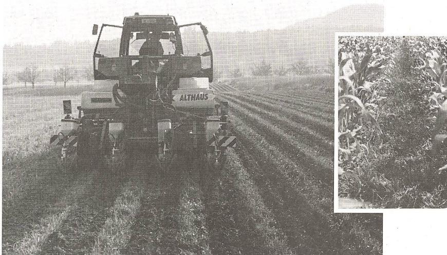
**«Maiswiese».** Mit dieser Bestellkombination fräsen Lohnunternehmer nach dem Frühjahrsschnitt 30 cm breite Streifen und lockern mit den vorlaufenden Grubenzinken knapp unterhalb der Bearbeitungsgrenze. Gleichzeitig erfolgen die Reihendüngung, die Einzelkornsaat und die Bandspritzung. Die quasi permanente Oberflächenbedeckung und Bodendurchwurzelung wirken sich besonders vorteilhaft auf Regenwasser-Infiltration und Befahrbarkeit sowie Bodenbiologie aus.
