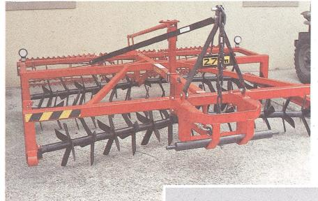
**Spatenrollegge.** Dieses universelle, leichtzügige Gerät ermöglicht eine flache, strukturerhaltende und kostengünstige Bodenbearbeitung – mit oder ohne Pflanzenreste.
