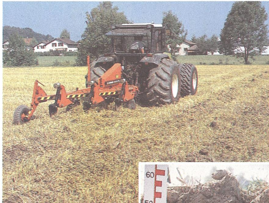
**Parapflug.** Die schräggestellten Scharen brechen den Boden auf und heben ihn leicht an. Bei tonreichen Böden ermöglicht erst der Einsatz dieses Gerätes Lockerungstiefen unterhalb der Pflugsohle. Nur unter brüchigen, warmen Bedingungen wird das Bodengefüge rasch biologisch verbaut sowie wassersparend und nachhaltig gelockert.
