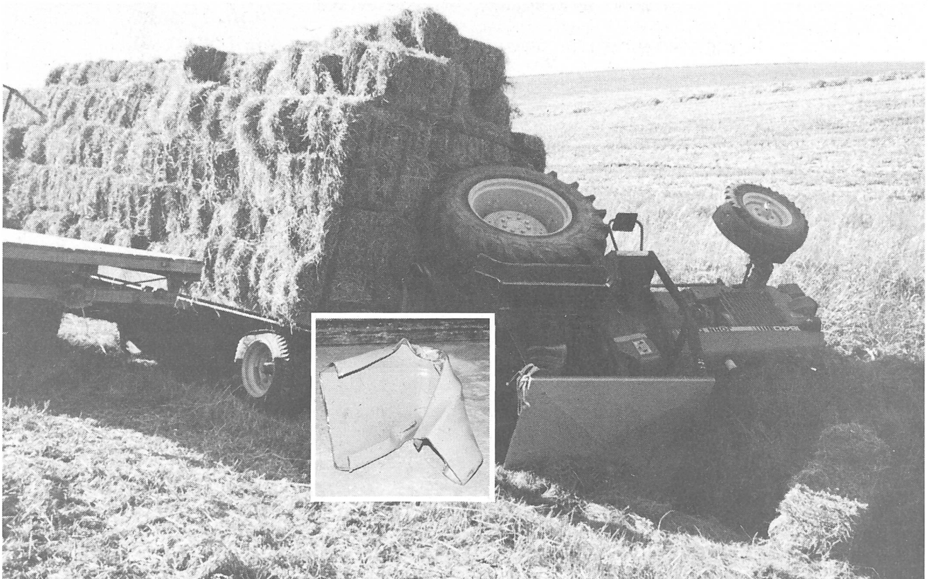
Glück im Unglück keine Verletzten und verhältnismässig geringer Sachschaden dank Sicherheitskabine. Die Detailaufnahme zeigt die um den Unterlenker geknickte Anhängerdeichsel.
