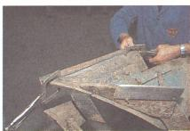
2. Kupferstab 50 x 10 x 500 mm (Bezugsquelle: SVLT) an die Schneide klemmen und evtl. mit Hammerschlägen genau an die Schneidenform anpassen. Der Stab gibt dem Schmelzbad Halt, leitet die Wärme ab, so dass sich der Stahl nicht zu stark erwärmt, und garantiert als «Lineal» eine schmale, gleichmässige Schweissraupe.
