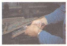
5. Aus materialtechnischen Gründen sollen nur 1 – 2 Lagen aufgetragen werden. Lässt sich die Schlacke leicht entfernen, so ist dies ein Zeichen für die richtige Schweisstromeinstellung und Elektrodenführung. Allfällige Querrisse in der Schweissraupe der zweiten Lage haben keinen Einfluss auf die Arbeitsqualität.
