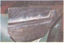
7. Hartauftragschweissen an der Pfluganlage und Einsetzen eines Flachstahls. Bei Mehrscharpflügen lohnt sich diese Reparatur besonders an der stark beanspruchten Anlage des hintersten Pflugkörpers.
