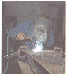
4. Die Elektrode in steilem Winkel zur Schneide und leicht in Schweissrichtung geneigt dem Kupferlineal entlangführen. Die Abbrennintensität der Elektrode ergibt den richtigen Vorschub. Fälschlicherweise wird die Elektrode oft «gezogen».
