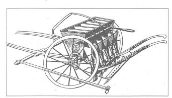
Abb. 1: Die erste einsatzfähige Drill-Sämaschine wurde 1785 von James Cooke, Pfarrer in Heaton/England, entwickelt.
