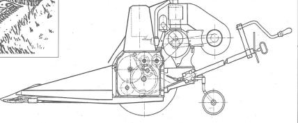
Abb. 4: Schnittzeichnung durch den ersten Rapid-Motormäher, dessen Grundprinzip viele Nachahmer fand. Weltweit wurden seither gegen eine Million Motormäher gebaut.
