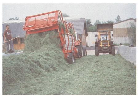
Abb. 3: Pro m³ Ladewageninhalt sind mindestens 1 m Silolänge notwendig, sonst wird der abgelegte Walm zu hoch.
