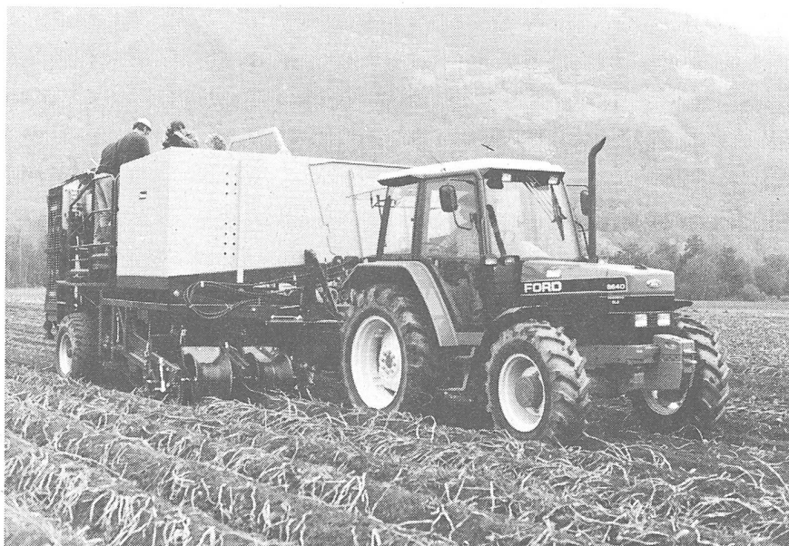
Abb. 5: Speziell für die Anforderungen in der Schweiz ausgelegter zweireihiger Vollernter mit Seitendammaufnahme und Hangaussgleich sowie voller Ausrüstung für die Ausscheidung der Beimengungen (Samro).
