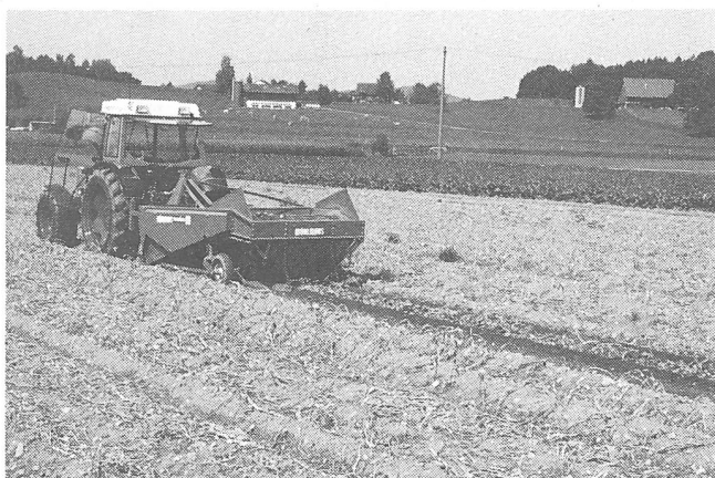
Abb. 2 und 3: Die geteilte Ernte wird in Europa überwiegend zwei- und vierreihig praktiziert. Beim zweireihigen Verfahren kommen einfache Schwadleger (2) eher ohne Krauttrennelemente und umgerüstete einreihige Kartoffelvollernter (3) zum Einsatz. Die Förder- und Trennorgane müssen eventuell für die höheren Knollendurchsätze (zwei Reihen) angepasst werden.
