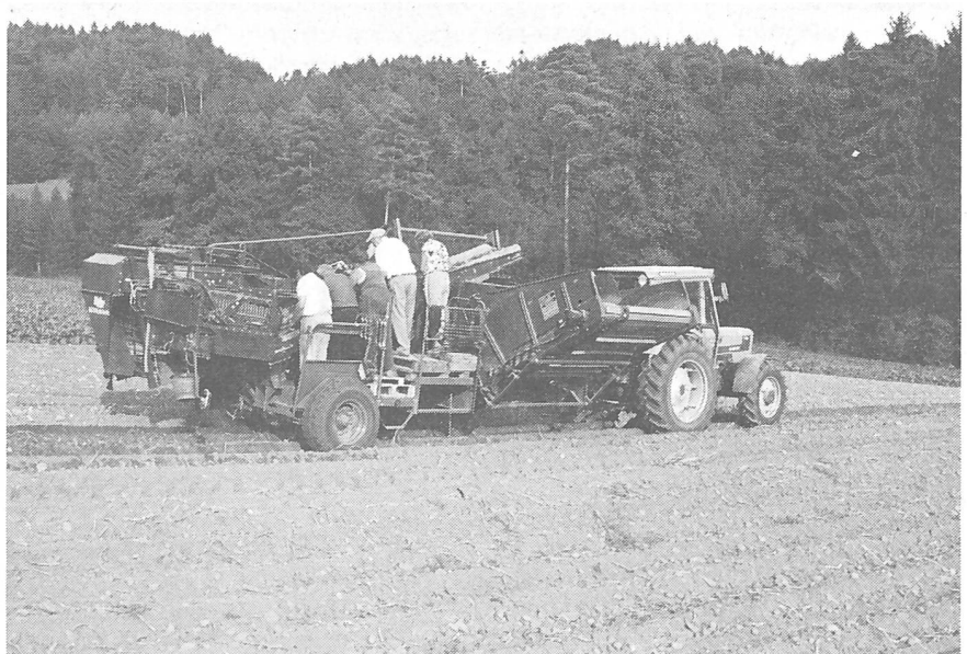
Abb. 1: Grosser einreihiger Vollernter mit leistungsfähigen Trennelementen und Sortiereinrichtung. Auch der Umschlag der Kleinknollen erfolgt hier im Loseverfahren.
