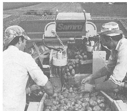
Abb. 11: Horizontal rotierende Kammabstreifer über zwei Noppenbänder (Samro).
