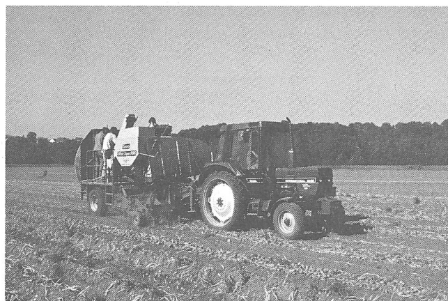
Abb. 2 und 3: Die geteilte Ernte wird in Europa überwiegend zwei- und vierreihig praktiziert. Beim zweireihigen Verfahren kommen einfache Schwadleger (2) eher ohne Krauttrennelemente und umgerüstete einreihige Kartoffelvollernter (3) zum Einsatz. Die Förder- und Trennorgane müssen eventuell für die höheren Knollendurchsätze (zwei Reihen) angepasst werden.
