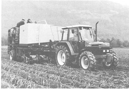
Abb. 5: Speziell für die Anforderungen in der Schweiz ausgelegter zweireihiger Vollernter mit Seitendammaufnahme und Hangausgleich sowie voller Ausrüstung für die Ausscheidung der Beimengungen (Samro).
