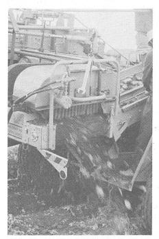
Abb. 12: Vertikal rotierender Dreifach-Kammabstreifer über einem Noppenband (Wisent).
