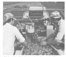
Abb. 11: Horizontal rotierende Kammabstreifer über zwei Noppenbänder (Samro).
