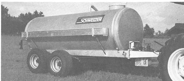
Pumptankwagen Schweizer 6500 l mit funkgesteuerter Schneckenpumpe 16 bar, mit Pendel-Tandemachse.
