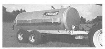
Pumptankwagen Schweizer 6500 I mit funkgesteuerter Schneckenpumpe 16 bar, mit Pendel-Tandemachse.
