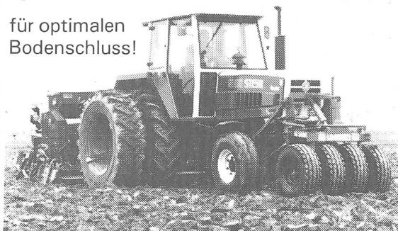
Verhindert Bodenverdichtung und erlaubt das Säen gleich nach dem Pflügen im Einmann-Passage-Verfahren.
