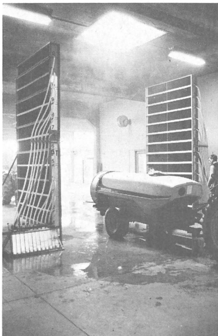
In Saxon und im Centre des Fougères in Conthey sind rund 40 Gebläsespritzen dem Test im Lammellenprüfstand der FAT unterzogen worden.
