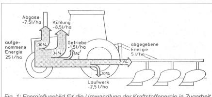
Fig. 1: Energieflussbild für die Umwandlung der Kraftstoffenergie in Zugarbeit.
