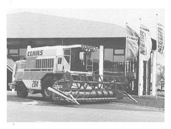
Der Mega 204 lässt sich deshalb nicht mit Maschinen ähnlicher Grösse mit ca. 1,3 m Trommelbreite vergleichen. Er erreicht die Durchsatzleistung der klassischen 6-Schüttler-Maschinen mit kompakteren Ausmassen und mit reduzierten Betriebskosten.
