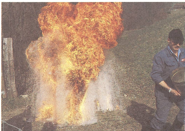
Demonstration: Fatale Wirkung beim Versuch, einen Ölbrand (Pommes-frites-Pfanne) mit Wasser zu löschen! Wenn es die Situation noch zulässt, ist ein solches Feuer mit einem (feuchten) Tuch oder einer Decke zu ersticken.
