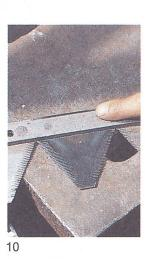
8. Wichtig: mit dem Hammer die beiden Nieten vorstauchen. Damit werden sie in den Bohrungen von Messerstab und Messerklinge für die Vernietung mit dem Nietwerkzeug festgeklemmt.
