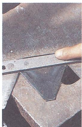
8. Wichtig: mit dem Hammer die beiden Nieten vorstauchen. Damit werden sie in den Bohrungen von Messerstab und Messerklinge für die Vernietung mit dem Nietwerkzeug festgeklemmt.
