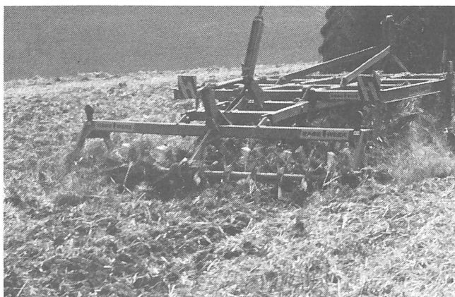
Abb. 4: Nachläufer krümelnd und ebenen den Boden ein. Im Gegensatz zur Messerrollegge (RabM links) rückverfestigt die Schlepp mit Flachstabwalze den Boden (RabW rechts).
