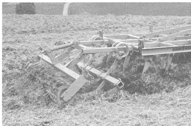
Abb. 4: Nachläufer krümelnd und ebenen den Boden ein. Im Gegensatz zur Messerrollegge (RabM links) rückverfestigt die Schlepp mit Flachstabwalze den Boden (RabW rechts).
