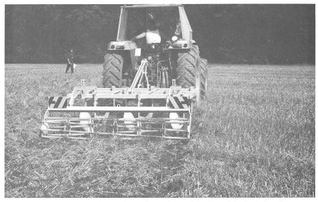
Abb. 9: Der Scheibengrubber (Lemk) bewirkt bei flachen Arbeitstiefen eine ganzflächige Arbeit, was sich für die Unkrautbekämpfung günstig auswirkt. Die Durchmischung des Bodens durch die Zinken in Kombination mit Scheiben befriedigt bei Arbeitstiefen bis ca. 15 cm gut.
