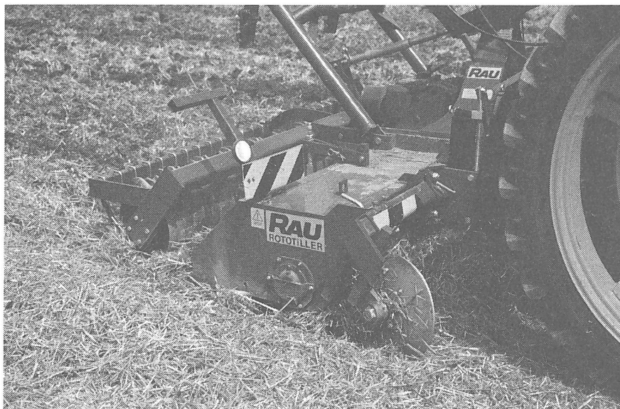
Abb. 18: Der Zinkenrotor (Rau) bearbeitet den Boden ganzflächig und intensiv. Eine möglichst hohe Fahrgeschwindigkeit und eine möglichst niedrige Rotordrehzahl sind mit den zapfwellengetriebenen Geräten generell einzuhalten.
