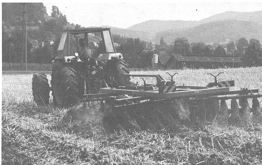
Abb. 15: Die Scheibenegge (Quiv) schält den Boden ganzflächig, wodurch Unkraut gut erfasst wird. Die Stützräder erlaubten immer eine exakte Tiefenführung.
