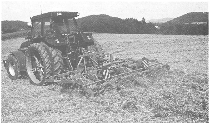
Abb. 10: Für den Transport wird die Grossfederzinkenegge (Koec) hydraulisch zusammengeklappt, die Handhabung ist problemlos.
