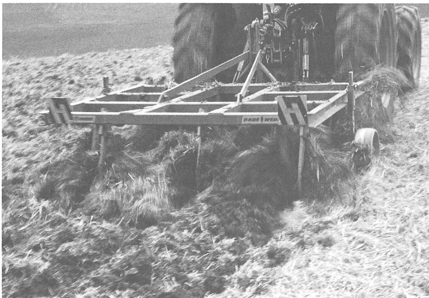
Abb. 3: Der Doppelherzschargrubber (RabO) zeichnet sich durch eine gute Durchmischung des Bodens aus.
